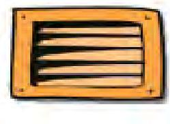
Gli apparecchi di tipo C con circuito di combustione stagno, non avendo necessità di prelevare l'aria dal locale d'installazione, non necessitano di aperture permanenti di ventilazione.
