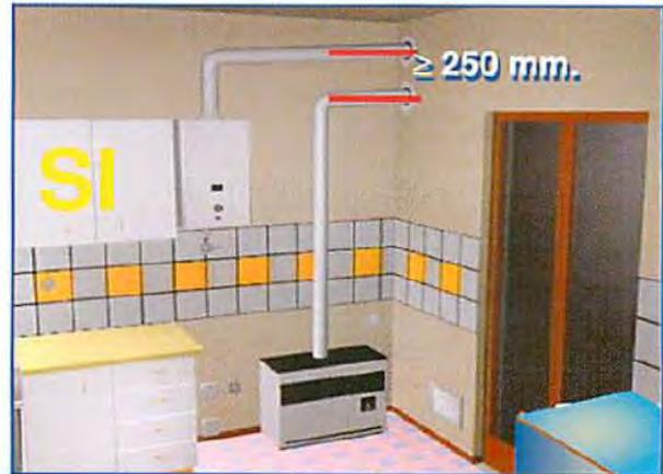
Il condotto di scarico deve rispondere ai medesimi requisiti di cui alla scheda n. 30 foglio 3 di 6 per i canali da fumo, e deve avere la parte ad andamento sub-orizzontale ridotta al minimo e comunque di lunghezza nella parte interna dell'edificio, **non maggiore di 1000 mm.**
