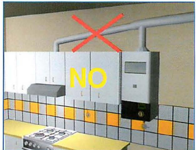
Se lo scarico avviene in un camino singolo il canale da fumo può ricevere lo scarico al massimo di **due apparecchi**.
