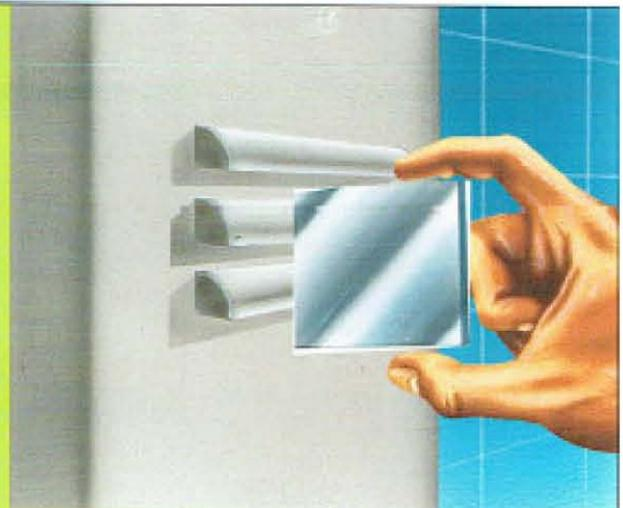
Accostate lo specchietto alle aperture in corrispondenza del dispositivo rompitiraggio-antivento tenendolo come indicato nella figura e facendolo scorrere lungo le aperture
