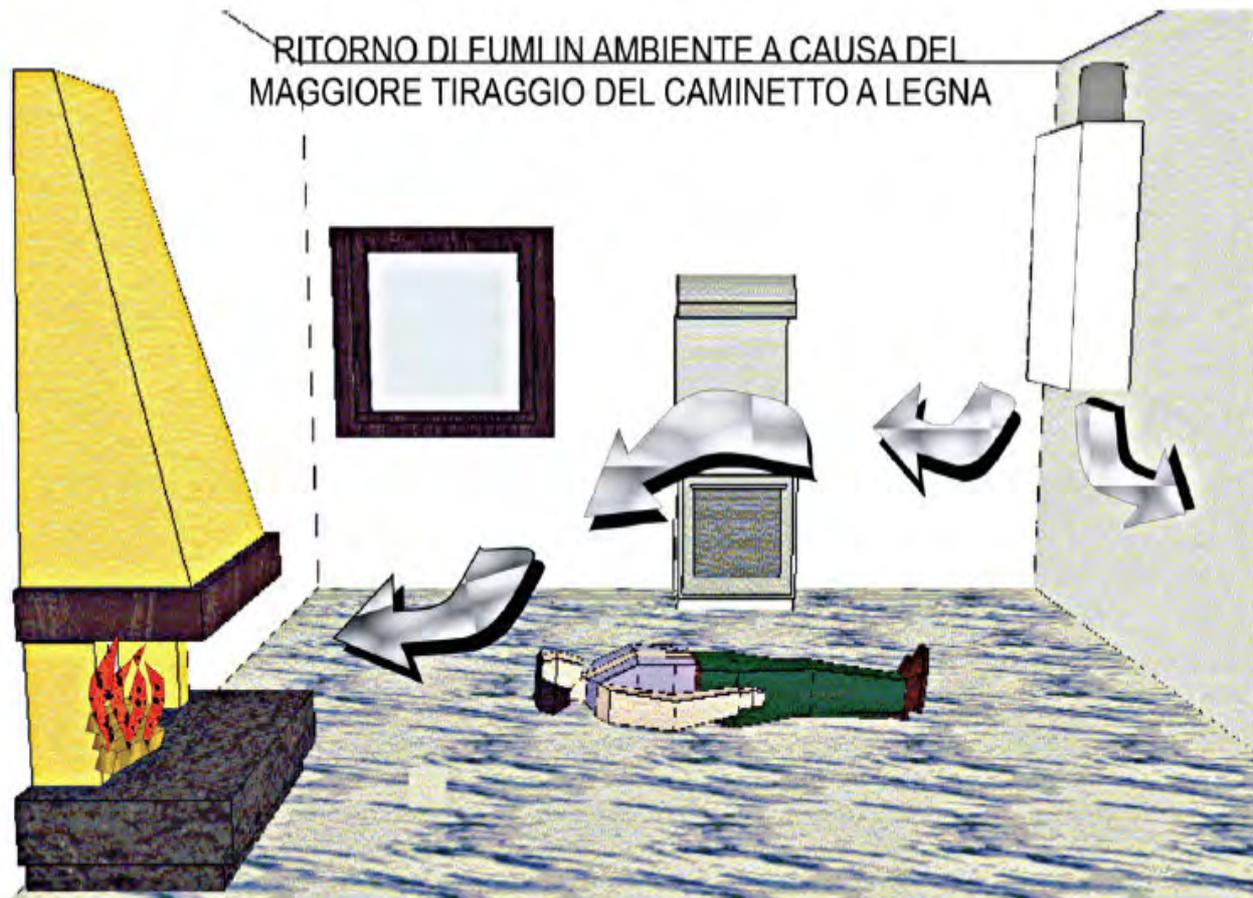
L'ultimo gruppo di cause che concorrono al verificarsi degli incidenti è costituito dalla **carenza di manutenzione**. Gli apparecchi di riscaldamento (come le caldaie) devono essere mantenuti periodicamente secondo le istruzioni fornite dai costruttori degli apparecchi stessi.
