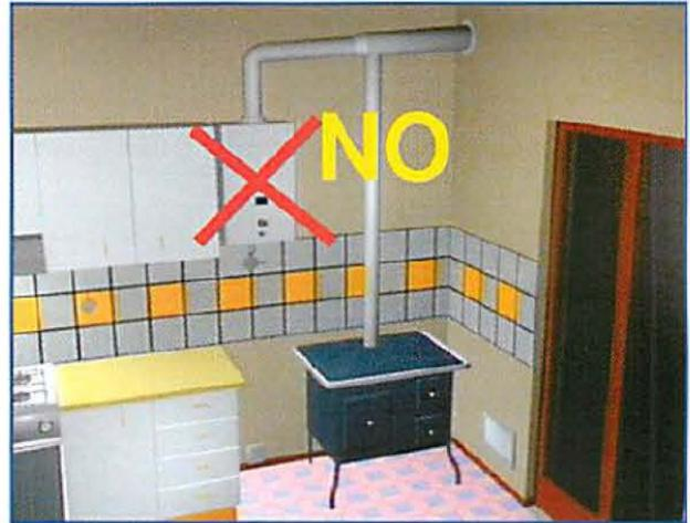
È vietato convogliare nello stesso canale da fumo lo scarico di apparecchi a gas ed i canali provenienti da cappe sovrastanti gli apparecchi di cottura.
