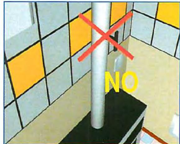
Il canale da fumo deve **distare almeno 500 mm** da **materiali combustibili e/o infiammabili**; se tale distanza non potesse essere mantenuta occorre provvedere ad una opportuna **protezione specifica al calore**.
