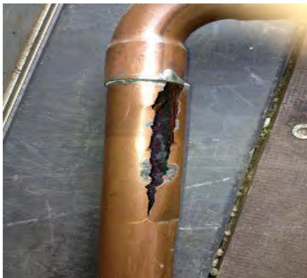
Nell'immagine si vede un tubo di rame, un metallo "nobile" con caratteristiche meccaniche e di ossidazione superiori ad altri metalli, di una caldaia installata da appena tre anni.
