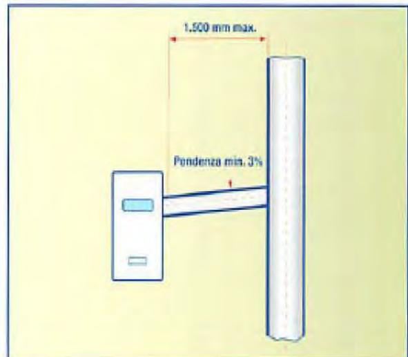
Per gli apparecchi con tubo di scarico posteriore o laterale, il canale da fumo **non deve presentare più di due cambiamenti di direzione**, compreso il raccordo di imbocco al camino e/o canna fumaria.
