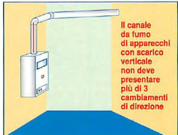
Per gli apparecchi con tubo di scarico posteriore o laterale, il canale da fumo deve avere una **lunghezza sub-orizzontale non maggiore di 1.500 mm**, (non maggiore di 1/4 dell'altezza efficace del camino).
