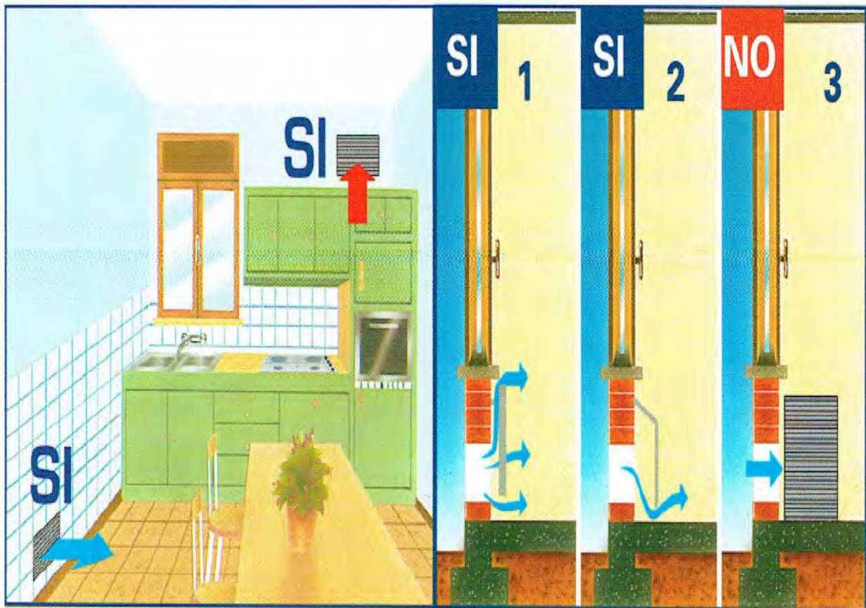
Il locale è provvisto di due adeguate aperture per l'aerazione e lo scarico dei fumi
