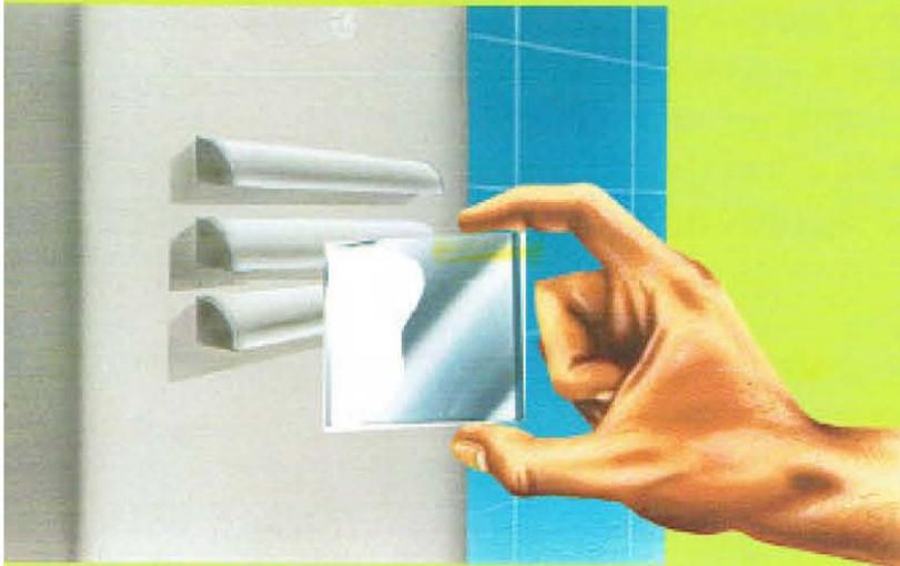
Controllate immediatamente lo specchio: se individuate delle zone di appannamento vuol dire che c'è un rientro nell'ambiente dei prodotti della combustione. E' necessario, quindi, controllare il camino e i condotti di scarico dei fumi.
