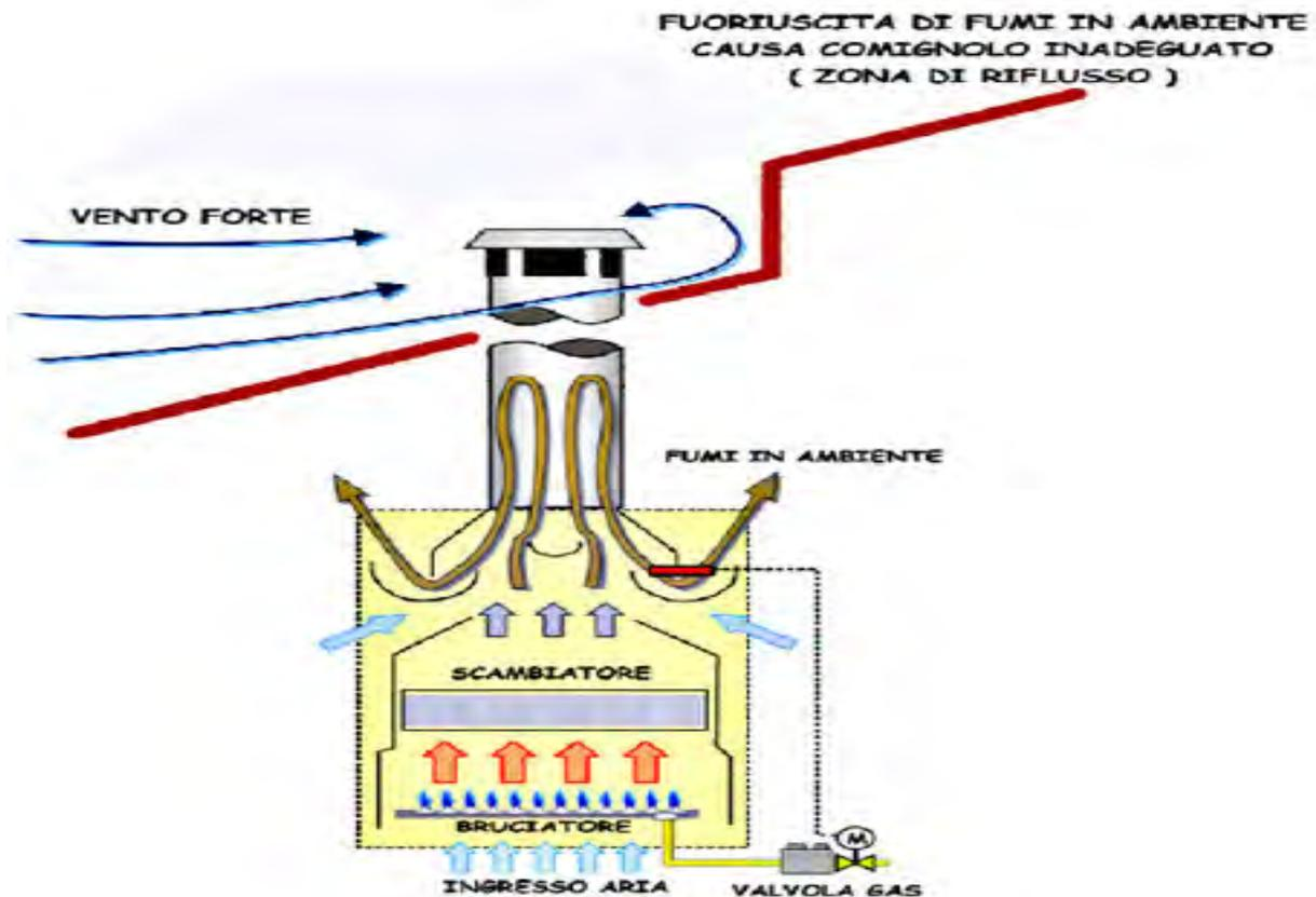
Una seconda serie di cause riconducibili al cattivo tiraggio sono i difetti indotti dall'utilizzo di apparecchi e sistemi che producono un **tiraggio contrario rispetto a quello sviluppato dal sistema di evacuazione dei prodotti della combustione**. E' il caso dell'utilizzo di caminetti a legna o di elettro-aspiratori.
